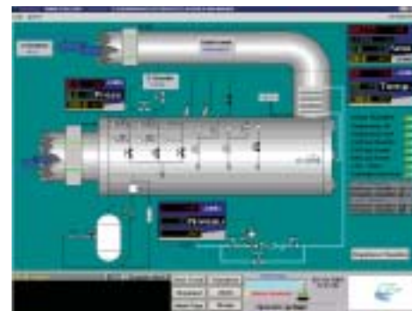
Schema relativo alla caldaia di recupero. Sono anche rappresentati i dati di portata, pressione, produzione di vapore e temperature in uscita.
