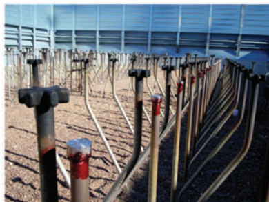
Vista interna della disposizione dei bruciatori per i vari stadi
